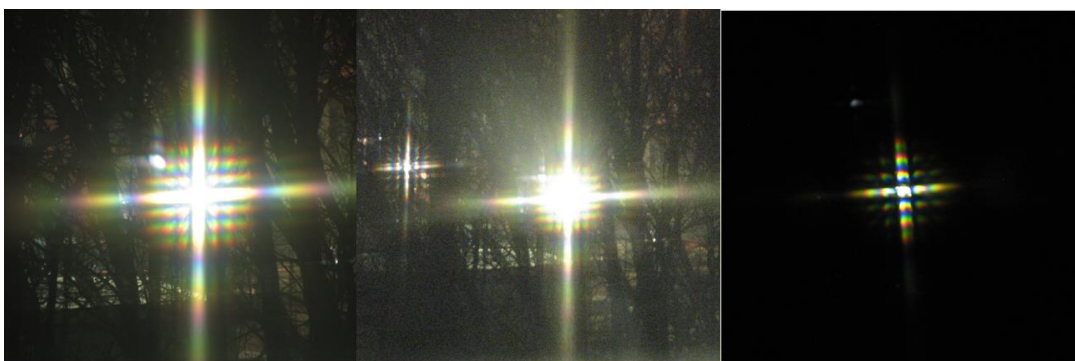
Rysunek 2.2. Dyfrakcja światła latarni ulicznej na firance utkanej z przeplatających się pod kątem prostym nitek; Z pracy inżynierskiej Agnieszki Juszczyk: „Obrazy dyfrakcyjne wokół nas”. Praca wykonana, pod kierunkiem J. Masajada, w Instytucie Fizyki Politechniki Wrocławskiej w 2012
