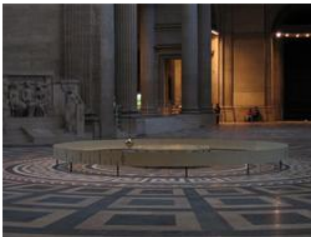
Rysunek 4.1. Z lewej: Najsłynniejsze wahadło Foucaulta zawieszone we francuskim Panteonie wiosną 1851 roku. Na linie o długości 63 metrów zawieszona jest 28kg metalowa kula. Okres obrotu płaszczyzny wahań wahadła to 32 godziny; z prawej: Zachowanie się wahadła Foucaulta na biegunie.
