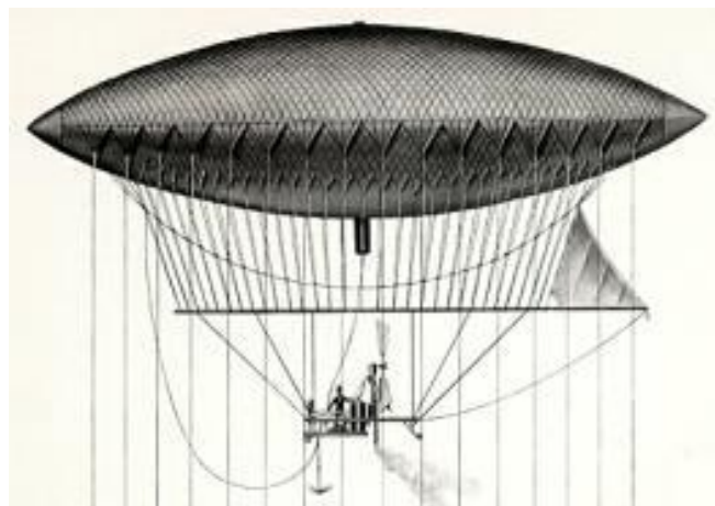
Rysunek 3.8. Balon sterowy Julesa Giffarda. Rycina z Meyers Blitz-Lexikon, Leipzig, 1932; źródło Wikipedia
