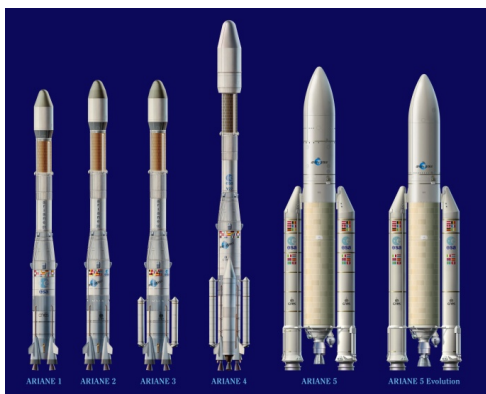
Rysunek 3.8.4. Z lewej rodzina rakiet Ariane; z prawej start rakiety Ariane 5V192, który miał miejsce 02.11.2009. Rakiet Ariane V jest obecnie eksploatowaną wersją rakiety. Przystosowana jest do wynoszenia ładunków do 21000kg (na niską orbitę Ziemi); Źródło zdjęć ESA.
