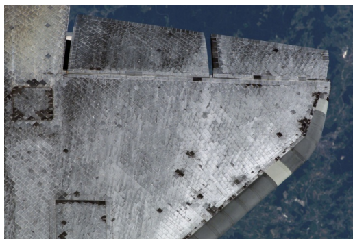
Rysunek 4.3.6. Zdjęcie spodu skrzydła wahadłowca Discovery pokryte żaroodpornymi płytkami; Źródło NASA
