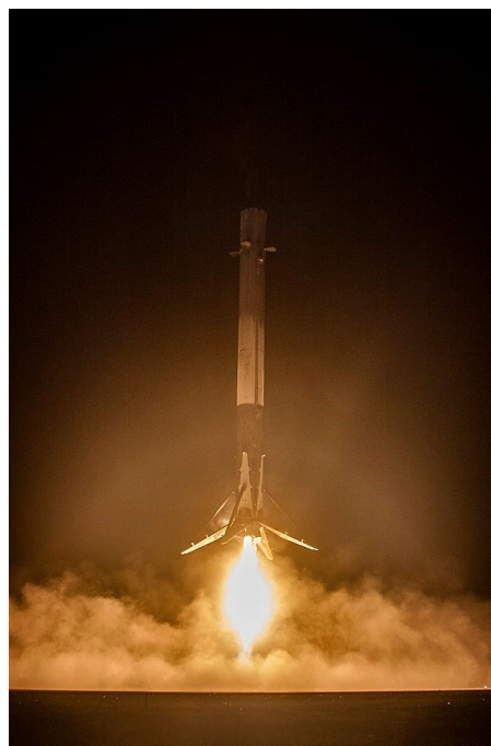
Rysunek 3.8.9. Rakieta Falcon 9 ze statkiem zaopatrzeniowym Dragon; start w październiku 2012 w celu dostarczenia zaopatrzenia do stacji ISS. Od 2020 roku załogowe wersje statku Dragon przewożą na ISS astronautów; z prawej lądowanie pierwszego członu rakiety Falcon 9; źródło zdjęć Wikipedia.
