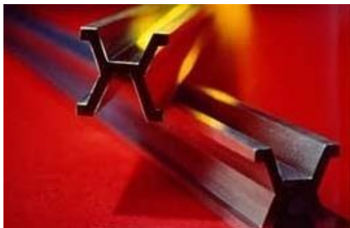
Rysunek 6.1.1. Wzorzec jednego metra z lat 1889-1960. Źródło zdjęcia Wikipedia
