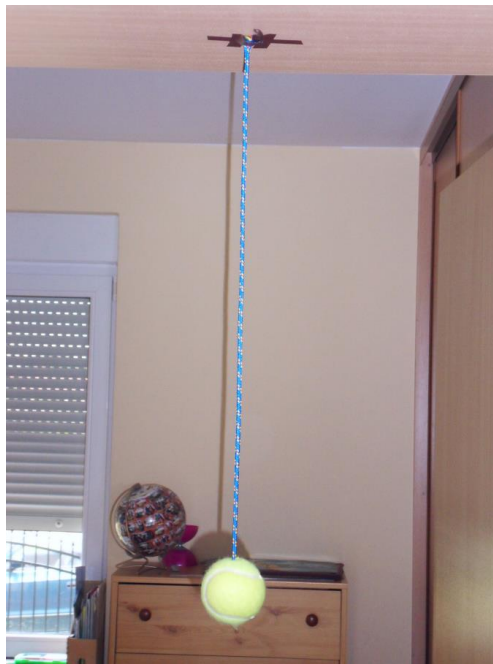
Rysunek 3.2. Moje wahadło składało się z dość sztywnej linki na końcu której powieszona została tenisowa piłeczka. U góry nić jest przymocowana do framugi drzwi kilkoma paskami mocnej taśmy klejącej.
